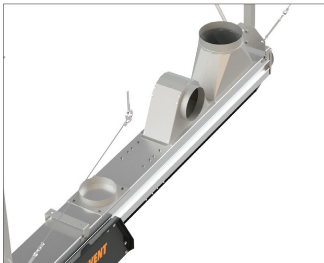
3B. Kanalsamlesættes del 1 monteres i kanalen med selvborende skruer.
