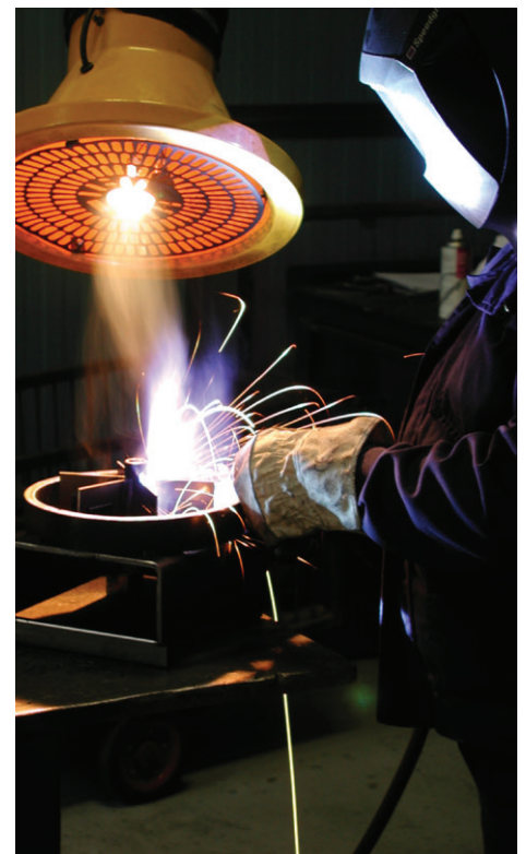
Der Wing Arm können wir mit eingebaute Licht, Start/Stopp Kontakt, manuell oder motorisierte
